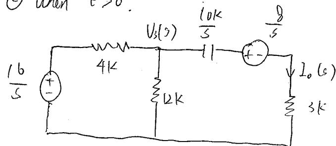
$$1) KCL: \frac{\frac{16}{s} - V_3(s)}{4k} = \frac{V_3(s)}{12k} + I_o(s)$$
