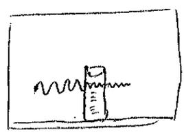
THE MICROWAVE IS IMPINGING ON THE WATER CUP FROM THE LEFT. THE MICROWAVE IS STRONGLY ATTENUATED INSIDE THE CUP & ITS ENERGY IS TRANSFERRED TO WATER MOLECULES. LOSS OF ~~ENERGY~~ MICROWAVE ENERGY APPEARS AS HEAT.
