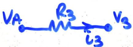
$\frac{V_A - V_3}{R_3} = i_3$
