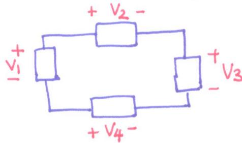
$$-V_1 + V_2 + V_3 - V_4 = 0$$
