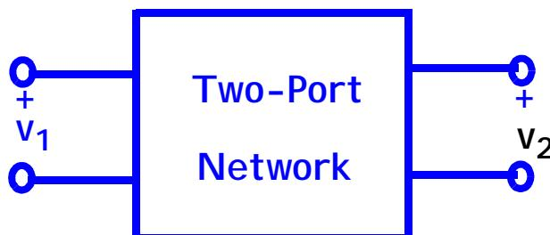
$$\begin{bmatrix} v_1 \\ i_2 \end{bmatrix} = \begin{bmatrix} h_{11} & h_{12} \\ h_{21} & h_{22} \end{bmatrix} \cdot \begin{bmatrix} i_1 \\ v_2 \end{bmatrix}$$
