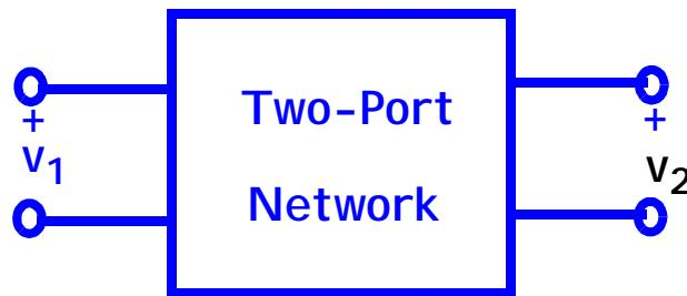
$$\begin{bmatrix} i_1 \\ i_2 \end{bmatrix} = \begin{bmatrix} y_{11} & y_{12} \\ y_{21} & y_{22} \end{bmatrix} \cdot \begin{bmatrix} v_1 \\ v_2 \end{bmatrix}$$
