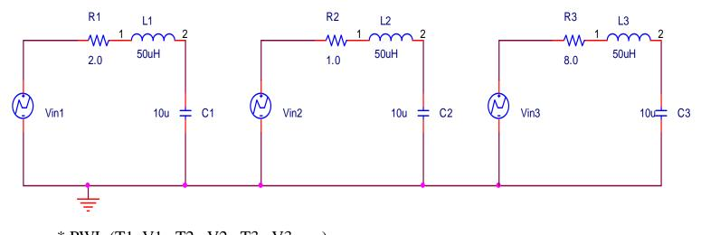
\* PWL (T1 V1 T2 V2 T3 V3 ...) Vin1 1 0 PWL (0 0 1NS 1V 1V) 1ms Vin2 4 0 PWL (0 0 1NS 1V) 1V 1ms Vin3 7 0 PWL (0 0 1NS 1V 1V) 1ms 2 **R**1 1 2 1.5V L1 2 3 50u C1 10u 3 0 R2 4 5 1 L2 5 50u 6 1.0V· C2 6 0 10u R3 7 8 8 8 L3 9 50u C3 9 0 10u 0.5V· .TRAN 1us 400us .PROBE .END 0V-50us . 100us 150us 200us 250us . 300us 350us 400us 0s □ V(C1:2) ◆ V(C2:2) ▼ V(C3:2) Time
